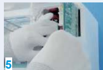
5 Extrageți placa electronică
