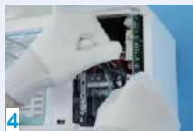
4 Îndepărtați bornele cablurilor
