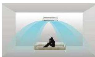
Aparatul de aer condiționat detectează poziția persoanei și orientează automat fluxul de aer în direcție opusă. Fluxul de aer va evita persoanele din cameră, pentru a le proteja sănătatea.
